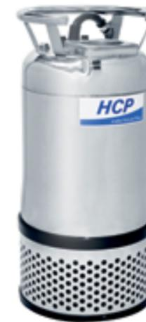
Tauchpumpen für den Einsatz auf engstem Raum: Die extraschlanken Pumpen der NAUTILUS-Serie werden überall dort eingesetzt, wo jeder Millimeter zählt. Die gesamte Modellreihe ist sehr schlank ausgeführt und arbeitet durch eine effiziente Mantelkühlung ausfallsicher. Eine doppelte Gleitringdichtung mit einem zusätzlichen Wellendichtring ermöglicht eine Eintauchtiefe bis 30 m.
